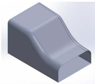
左モデルの角の部分は、左側はGW3Dfeatures「Blend Surface」でモデリング
